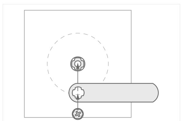
Prüfen, ob der Riegel im geschlossenen Zustand an dem Schließblech oder der Falz ausreichend Halt findet. Der Riegel sollte beim Schließen des Schließsystems ohne Druck oder Widerstand in seine Endposition gedreht werden können.
